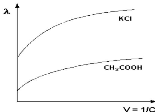
Рис. 5.9 Зависимость молярной электропроводности от разведения.
