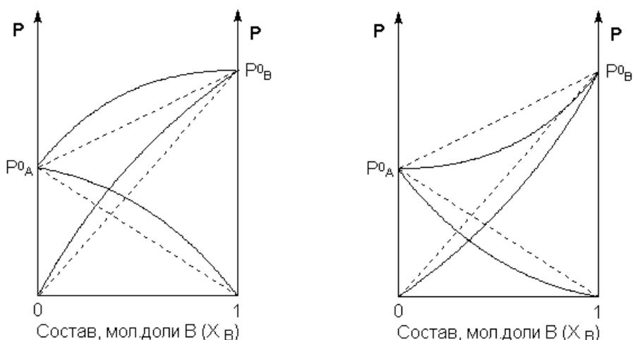
Рис. 5.4. Зависимость парциальных и общего давлений пара идеальных (штриховая линия) и реальных (сплошная линия) бинарных растворов от состава при положительных (слева) и отрицательных (справа) отклонениях от закона Рауля.
