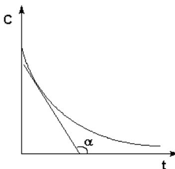
Рис. 3.2 Графическое определение  $V_{\text{ист}}$ .
