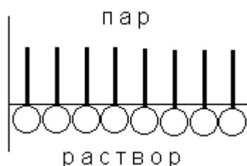
Рис. 7.3. Предельная ориентация молекул ПАВ в поверхностном слое.
