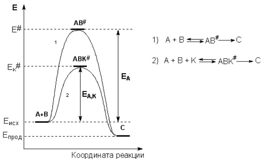
Рис. 3.8. Энергетическая диаграмма химической реакции без катализатора (1) и в присутствии катализатора (2).
