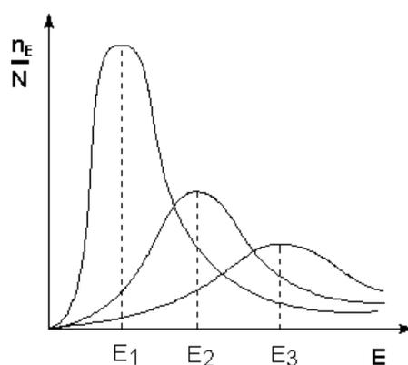
Рис. 3.6. Распределение частиц по энергии. Здесь  $\frac{n_E}{N}$  - доля частиц, обладающих энергией  $E$ ;  $E_i$  - средняя энергия частиц при температуре  $T_i$  ( $T_1 < T_2 < T_3$ ).
