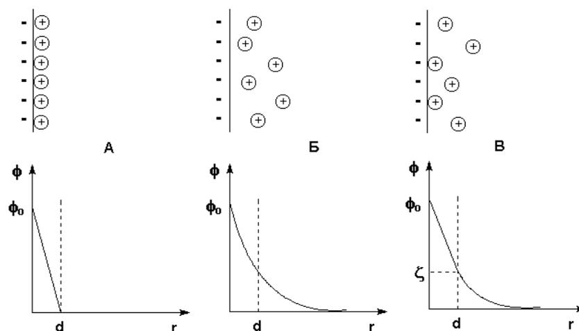
**Рис. 8.4.** Строение ДЭС: а) – по Гельмгольцу, б) – по Гуи, в) – по Штерну. Вверху – схема расположения противоионов, внизу – зависимость потенциала от расстояния.
