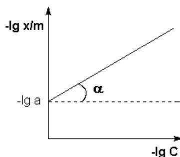
Рис. 7.7. Изотерма адсорбции Фрейндлиха в логарифмических координатах.
