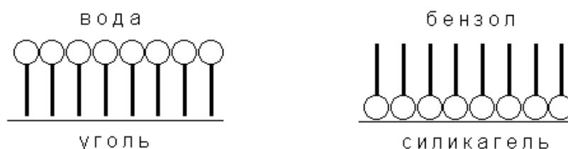
Рис. 7.8 Ориентация молекул ПАВ на поверхности адсорбента.
