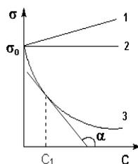
Рис. 7.1. Изотермы поверхностного натяжения растворов ПАВ (1, 2) и ПИАВ (3)
