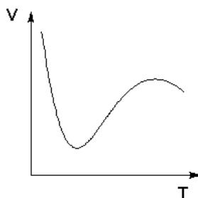
Рис. 7.4. Зависимость объема адсорбированного никелем водорода от температуры.
