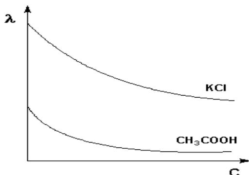
Рис. 5.8. Зависимость молярной электропроводности от концентрации.
