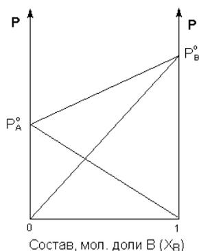
Рис. 5.3. Зависимость парциальных и общего давлений пара идеального раствора от концентрации.
