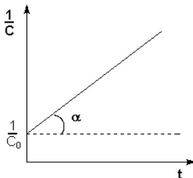
Рис. 3.4 Зависимость обратной концентрации от времени для реакций второго порядка.
