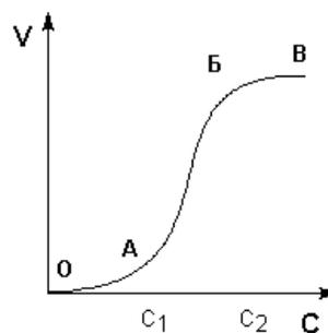
**Рис. 8.6** Зависимость скорости коагуляции от концентрации
