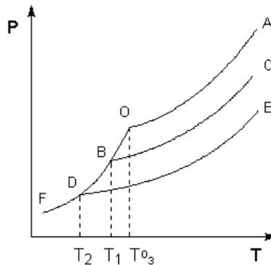
Рис. 5.5. Понижение температуры замерзания разбавленных растворов.
