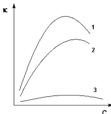
Рис. 5.7. Зависимость удельной электропроводности электролитов от концентрации (1 – H<sub>2</sub>SO<sub>4</sub>, 2 – KOH, 3 – CH<sub>3</sub>COOH).
